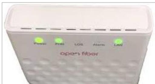
Se lo stato delle luci non corrisponde a quello della figura occorre interrompere l'installazione e contattare l'assistenza clienti.
